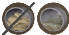
Заблокированный насос без системы измельчения
